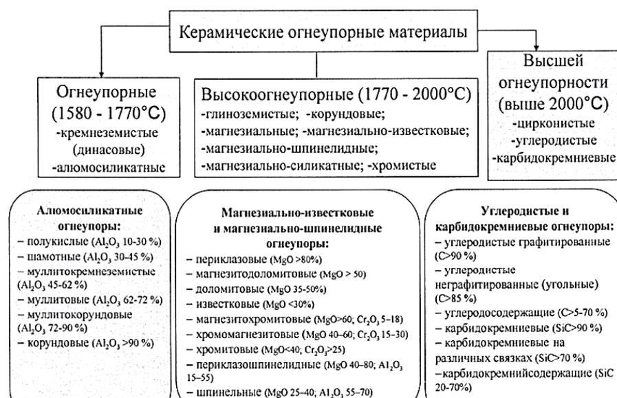
Рисунок 1 - Классификация огнеупорных материалов по огнеупорности
