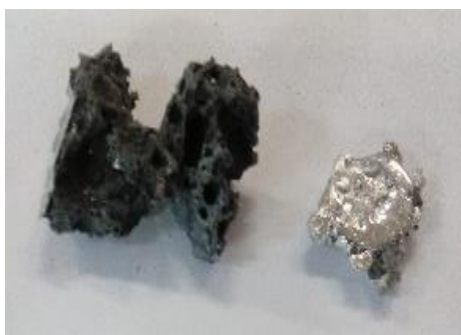
Рисунок 6– Результаты переплава продуктов плавки шлака с магнием.
