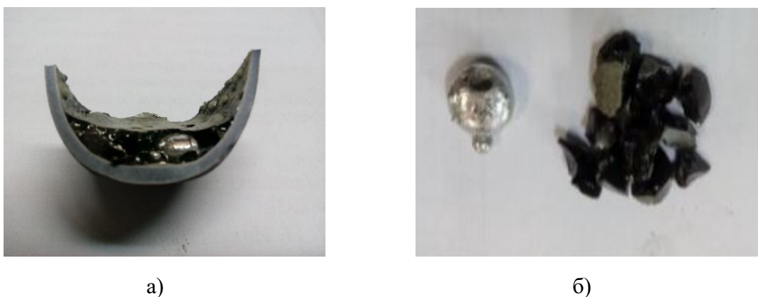
Рисунок 5– Результаты плавки шлаковой части изгари с оксидом бора. а-тигель с продуктами плавки; б-слиток олова и шлак;
