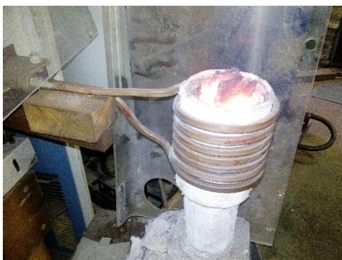
Рисунок 1 – Инверторная плавильная установка
