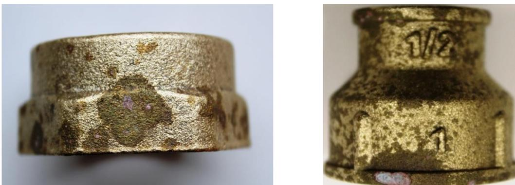
Рисунок 1 – Внешний вид поверхности отливок из сплава марки ЛЦ40С<sub>д</sub> пораженной пятнами
