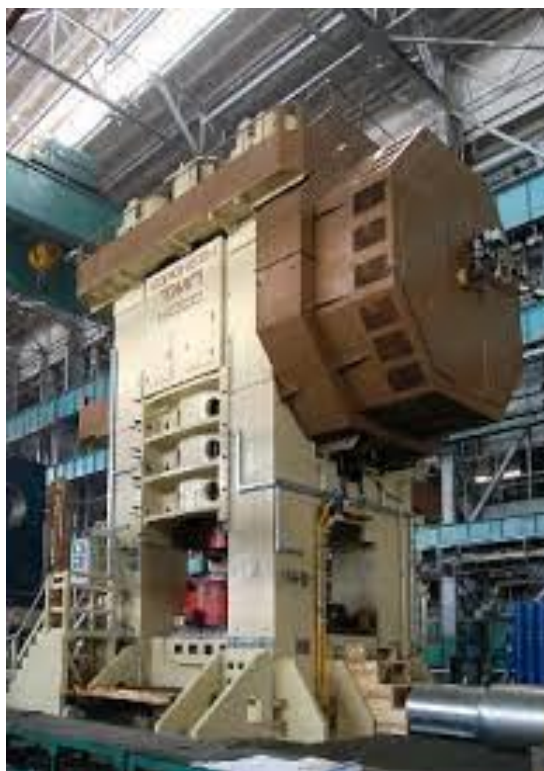
Рисунок 1 – Кривошипный горячештамповочный пресс (КГШП) модели КБ8540
