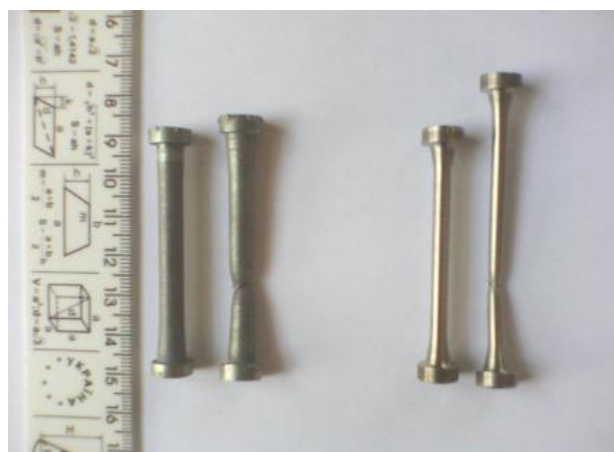
Рисунок 4 – Образцы до и после растяжения.
