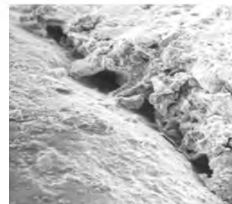
Рис. 3. Внутренний слой центрифугированного бетона (контактная зона) (макрофото, \times 700 )
