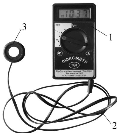
Рис. 2.2. Внешний вид люксметра «ТКА-ПКМ» (31):
