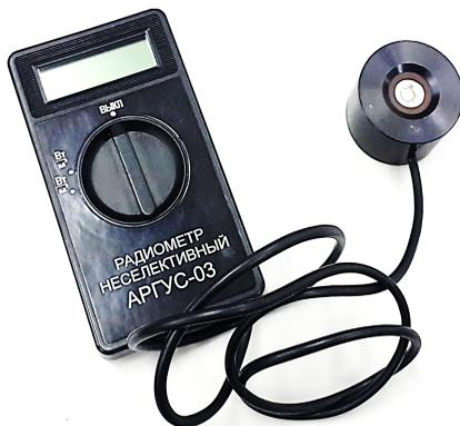
Рис. 3.9. Внешний вид радиометра «АРГУС-03»
