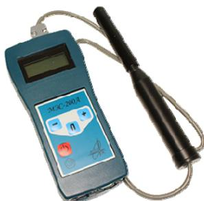
Рис. 3.1. Внешний вид метеометра МЭС-200А
