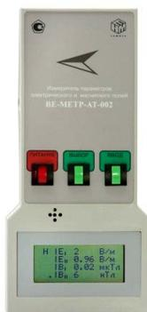
Рис. 7.1. Внешний вид измерителя электрического и магнитного полей ВЕ-метр-АТ-002
