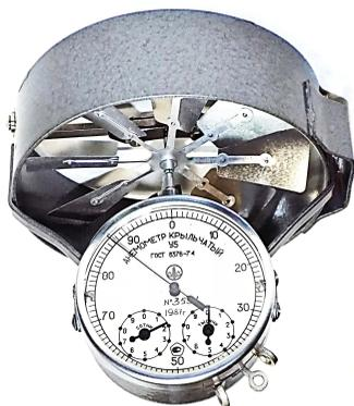
Рис. 3.5. Внешний вид крыльчатого анемометра
