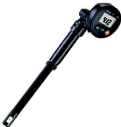
Рис. 3.7. Внешний вид термоанемометра Testo 405
