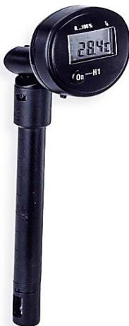
Рис. 3.3. Внешний вид гигрометра Testo 605
