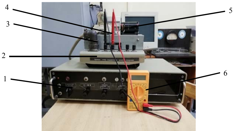
Рис. 7. Лабораторная установка: 1 – блок питания; 2 – универсальный блок; 3 – блок лабораторной работы; 4 – реле; 5 – исполнительный механизм (электродвигатель); 6 – мультиметр
