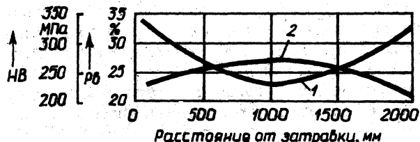
Рис. 1. Содержание свинца (1) и твердость (2) по длине заготовки
