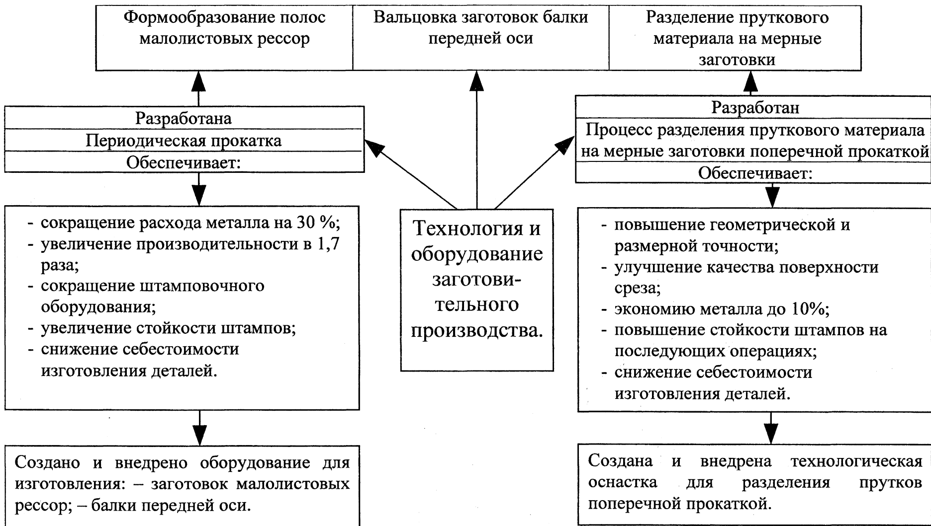
Рис. 2. Структурная схема разработанных технологий и оборудования в заготовительном производстве
