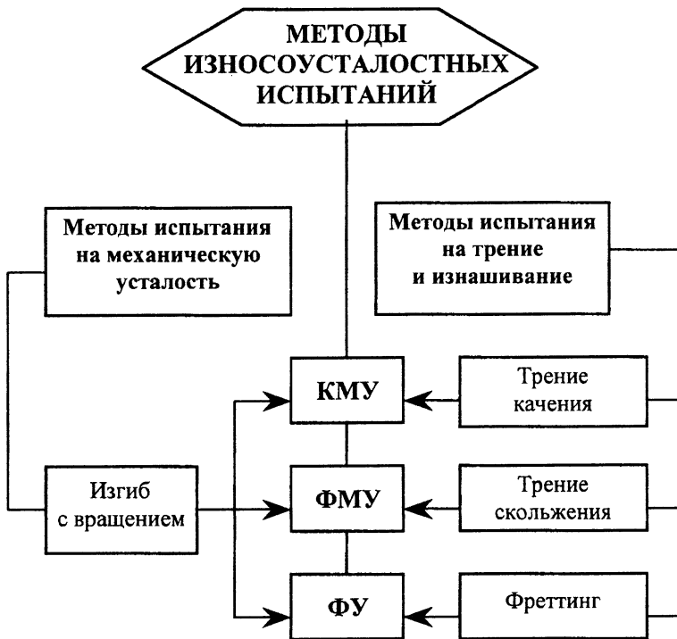
Рисунок 2. Формирование методов износоусталостных испытаний при главном вращательном движении: КМУ – контактно-механическая усталость; ФМУ – фрикционно-механическая усталость; ФУ – фреттинг-усталость
