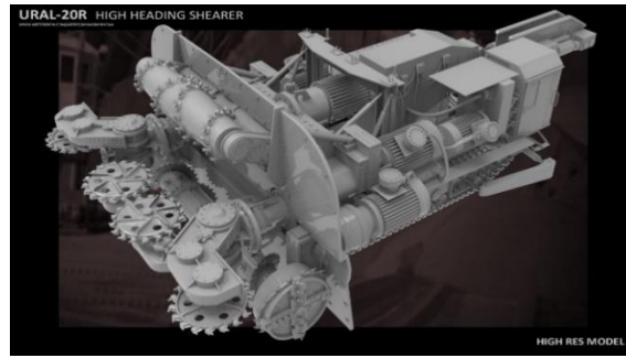
Рисунок 3 Комбайн проходческо-очистной «Урал-20Р» (вид сверху)
