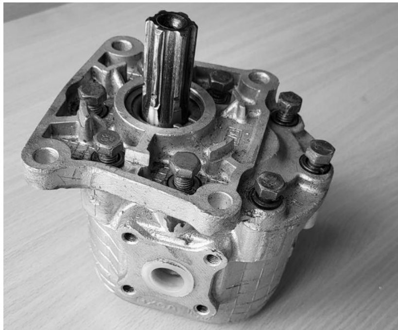
Рисунок 4. Насос шестеренчатый НШ-40 на кафедре «Детали машин»
