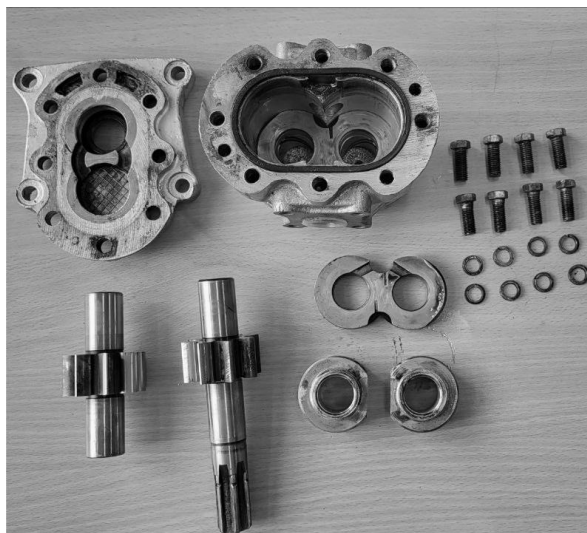
Рисунок 5. Насос шестеренчатый НШ-40 в разборе
