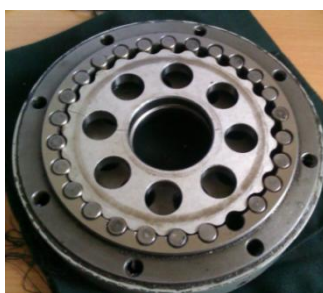
Рисунок 1. Планетарно-кривошипный механизм с цевочным зацеплением
