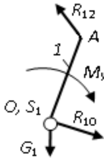
Рисунок 3. Схема сил, действующих на начальное звено.
