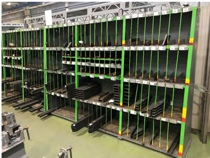
Рис. 4.2. Стеллаж Канбан в цехе кузовов ОАО «УКХ «БКМ»
