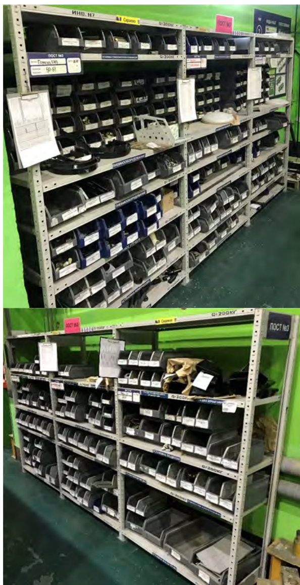
Рис. 5.8. Примеры стеллажей постового планирования в сборочном цехе ОАО «УКХ «БКМ»
