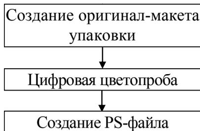
Рис. 7. Технологическая схема допечатных операций
