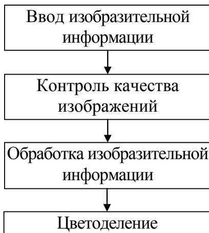
Рис. 2. Технологическая схема обработки изобразительной информации
