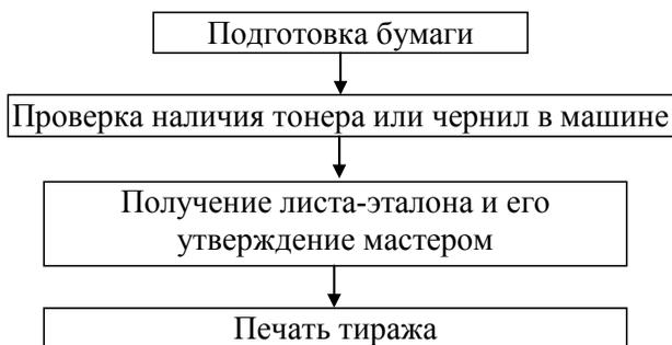
Рис. 21. Схема подготовки цифровой печатной машины к печати тиража
