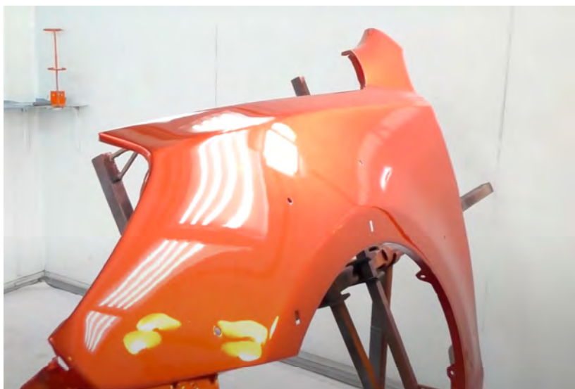
Рис. 3.15. Деталь после нанесения лака и сушки
