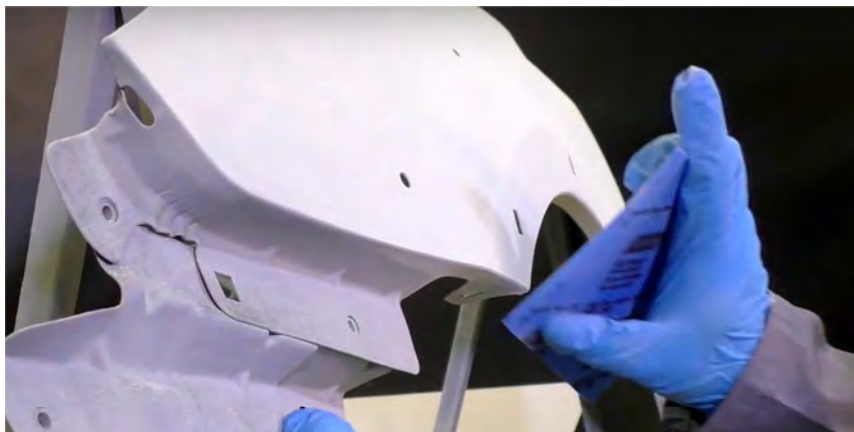
Рис. 3.10. Шлифование труднодоступных мест с помощью soft тач губки
