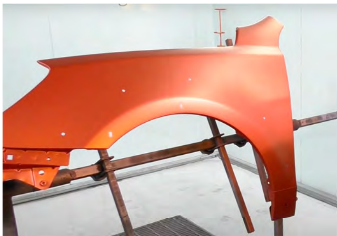
Рис. 3.14. Деталь после нанесения базового покрытия
