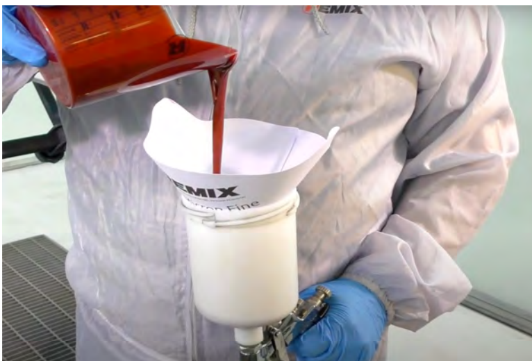
Рис. 3.12. Процесс наполнения краскопульты базовой эмалью
