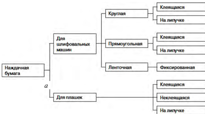
Рис. 1.8. Классификация наждачной бумаги
