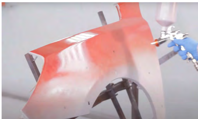
Рис. 3.13. Процесс нанесения базовой эмали первый слой
