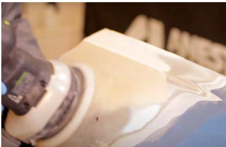
Рис. 3.5. Предварительное выравнивание поверхности
