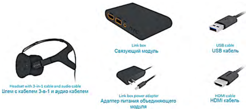
Рис. 2.6. Шлем и устройства для его подключения к компьютеру
