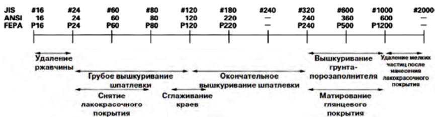
Рис. 1.11. Примеры использования наждачной бумаги по зернистости
