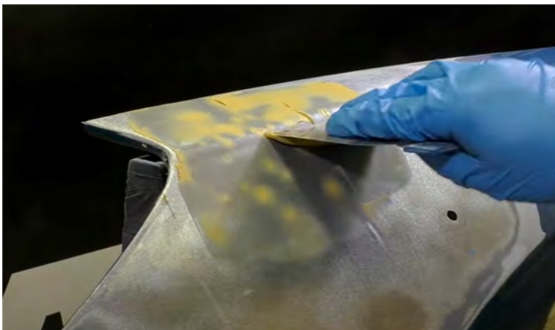
Рис. 3.3. Первый слой шпатлевки
