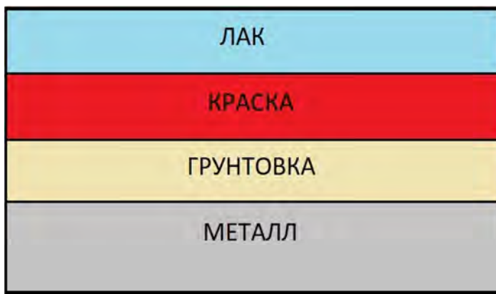
Рис. 2.8. Порядок расположения окрасочных слоев
