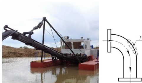
Рис. 1. Земснаряд для дноуглубительных работ и добычи речного песка с поворотным участком пульпопровода
