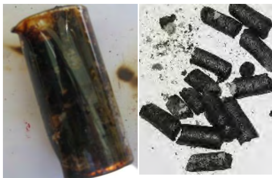
Рисунок 12 – Фотографии продуктов солнечного пиролиза биомассы
