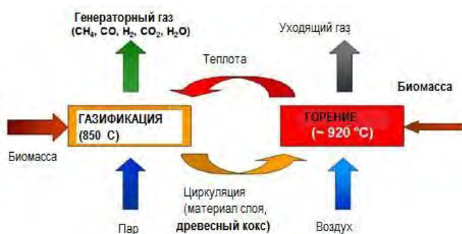
Рис. 22 – Схема (DFB) паровой газификации биомассы с прямым подводом тепла в двойном реакторе псевдоожиженного слоя [18]
