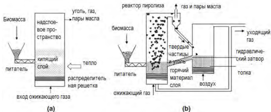
Рис. 17 . Реакторы пиролиза псевдооживленного (а) и циркулирующего кипящего слоя (b)
