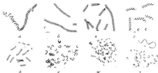
Рис. 1. Образцы стружки, полученные при точении с разными значениями главного угла в плане:
