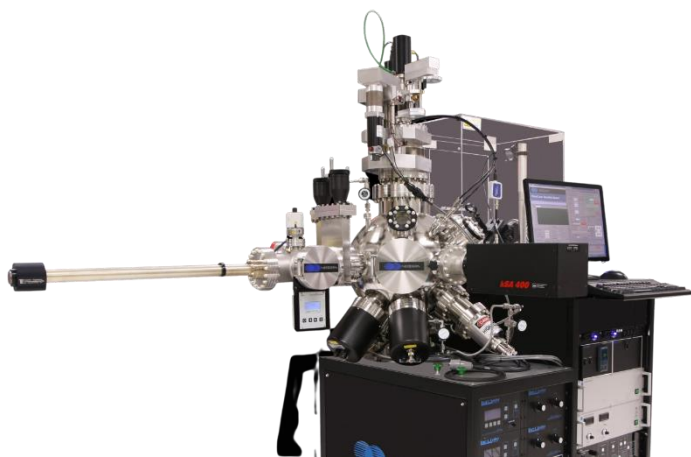
Рис. 1. Установка для лазерной абляции в вакууме «Pioneer 180 PLD System» от компании «Neocera LLC» [1]
