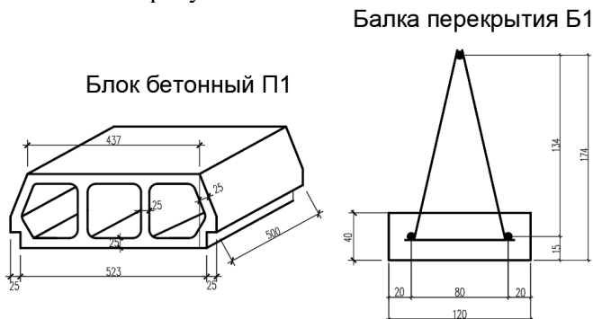
Рисунок 1 – Размеры элементов перекрытия
