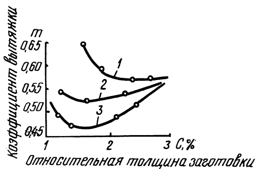
Рис. 2. Зависимость предельных коэффициентов вытяжки от относительной толщины заготовки: 1 — без прижима; 2 — вытяжка с прижимом без гидроподпора; 3 — вытяжка с гидроподпором.
