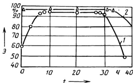
Рис. 1. Эффективность улавливания формальдегида в зависимости от длительности работы сорбента:
