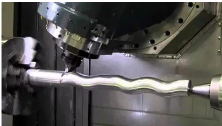
Рисунок 4 – Рабочая зона специального станка для обработки роторов насосов с круговой винтовой поверхностью
