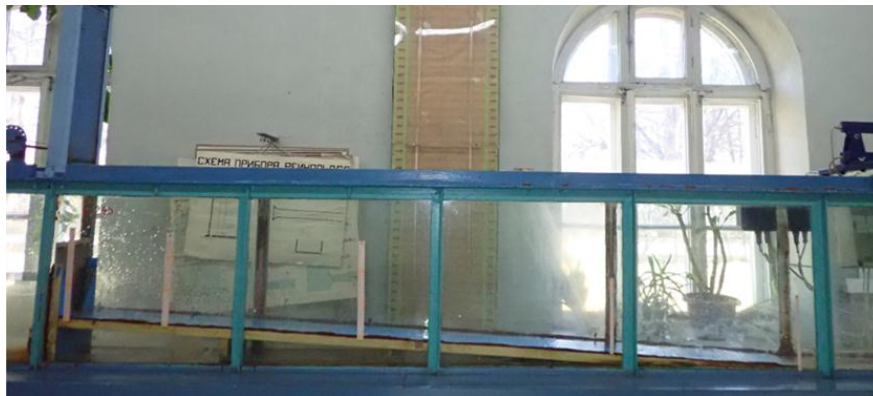
Рисунок 3 – Общий вид экспериментального лабораторного стенда с моделью нижнего бьефа (сухого русла)
