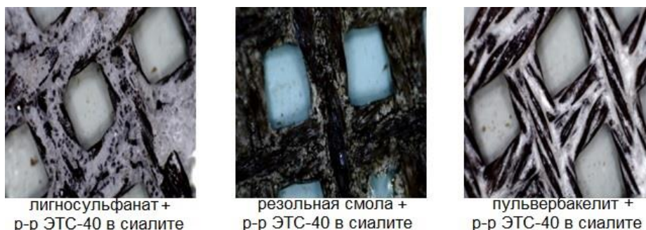
Рисунок 2 – Стеклосетка, обработанная комплексными связующими
