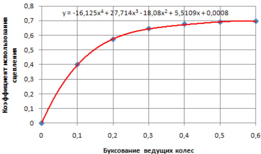
Рис. 7.3. Зависимость коэффициента использования сцепления от буксования ведущих колес
