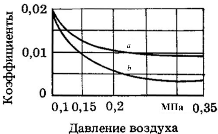
Рис. П1. График для определения коэффициентов a и b (формула 4)
