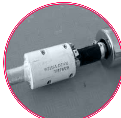
Рис. 2. Датчик для оценки мощности движений в тяжелой атлетике
