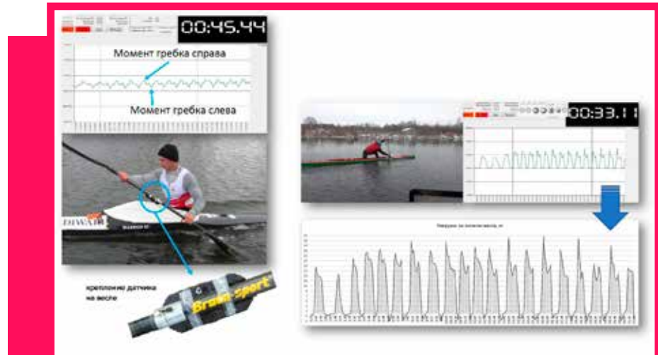
Рис. 1. Интеллектуальный датчик в исследовании мощности гребковых движений
