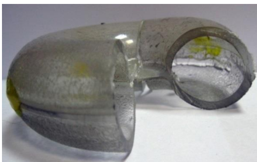
Рисунок 3 – Модель поворотного участка трубы земснаряда с круглой формой поперечного сечения
