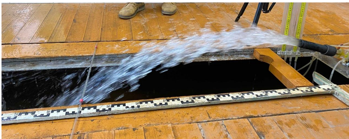
Рисунок 6 – Лабораторные испытания проведенные на модели поворотного участка трубы земснаряда с овальной формы поперечного сечения
