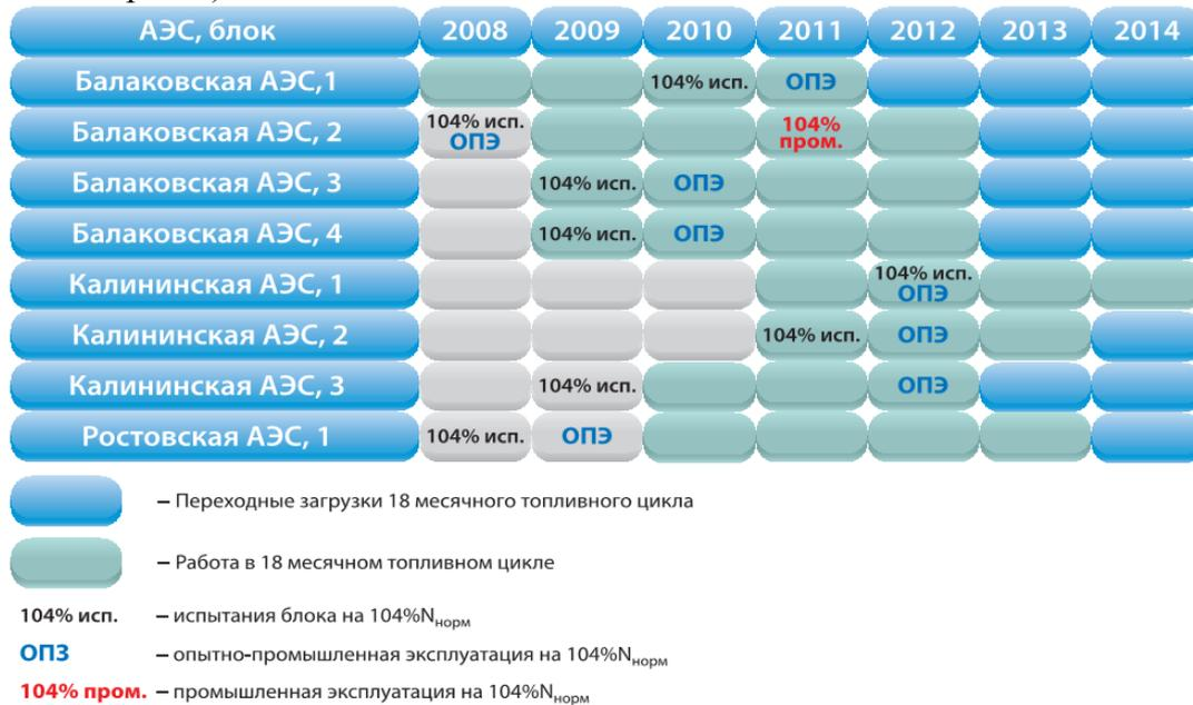
Рисунок 2 – График перевода энергоблоков ВВЭР-1000 на работу с повышенной мощностью в 18-месячном топливном цикле
