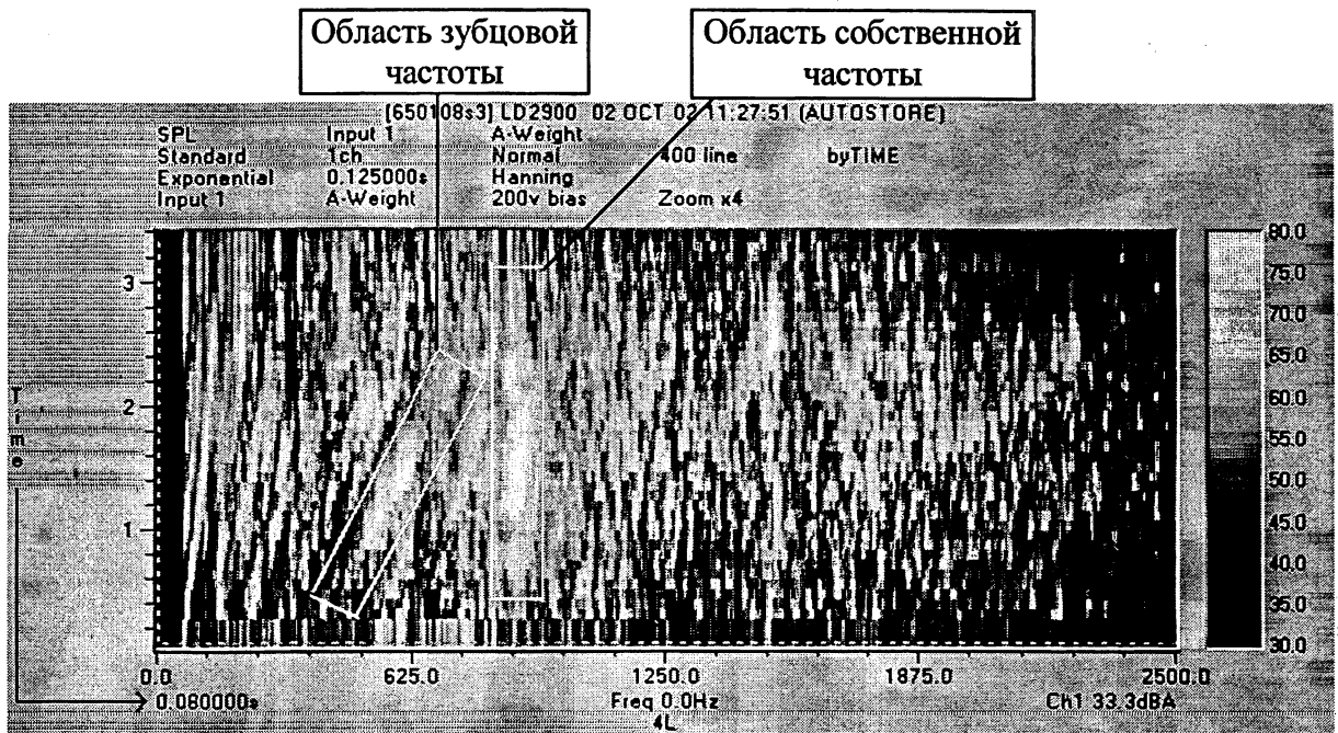
Рис 1.. Мультиспектры шума с левой стороны автомобиля MAZ-650108 при испытаниях на четвертой передаче.
