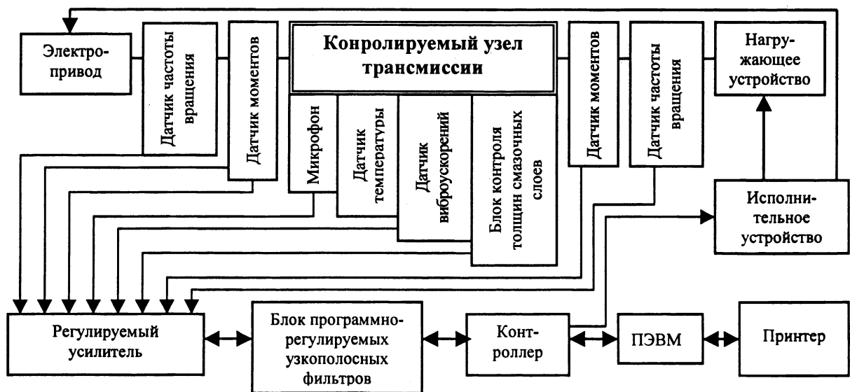
Рис. 2. Схема стенда для контроля качества изготовления и сборки узлов на основе зубчатых колес
