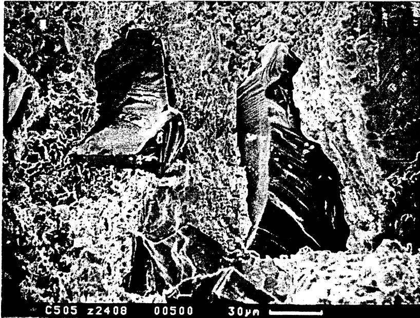
Рис. 2. Внешний вид излома алмазно-композиционного материала (связка M1 + Ti - 10% – алмаз AC6 100/80)
