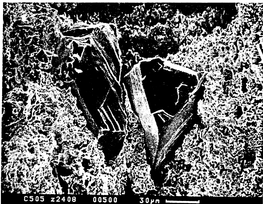
Рис. 1. Внешний вид излома алмазно-композиционного материала (связка М1 – алмаз АС6 100/80)
