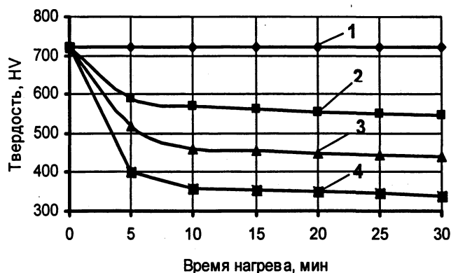
Рис.5.Изменение твердости стальной литой дроби производства МАЗ в процессе термообработки при индукционном нагреве: 1 - 200 °С, 2 - 320 °С, 3 - 400 °С, 4 - 450 °С
