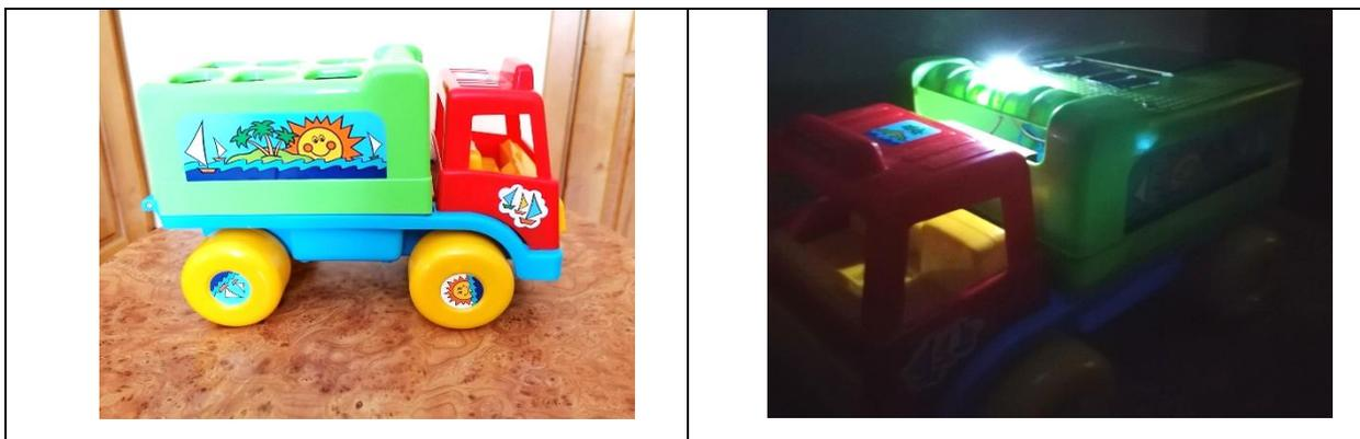
На грузовике размещаются солнечные батареи из отработавших свой срок калькуляторов, соединяются с диодной лампочкой, выключателем и аккумулятором от старого мобильного телефона. Аккумулятор накапливает энергию, которую преобразуют из солнечной энергии. Для увеличения времени горения лампочки размещается еще одну солнечную батарею.
