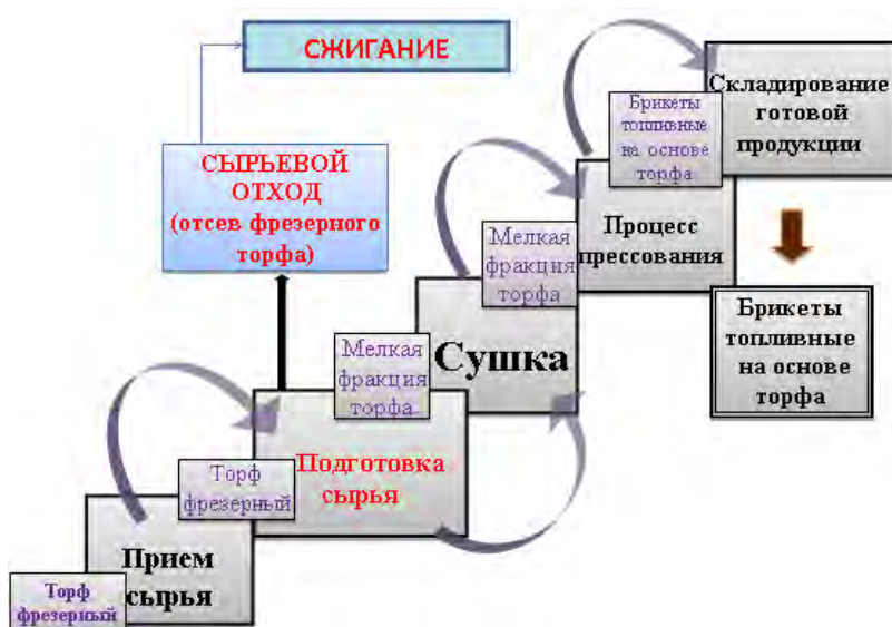
Рис. 1. Схема технологического процесса производства торфяных топливных брикетов
