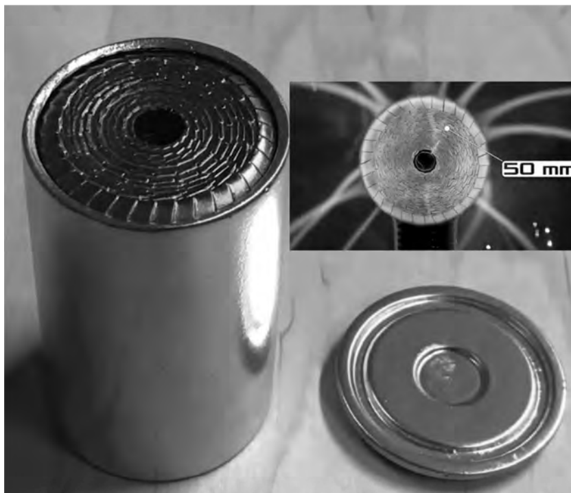
Рис. 1.12. Лазерная гравировка на катодной фольге
