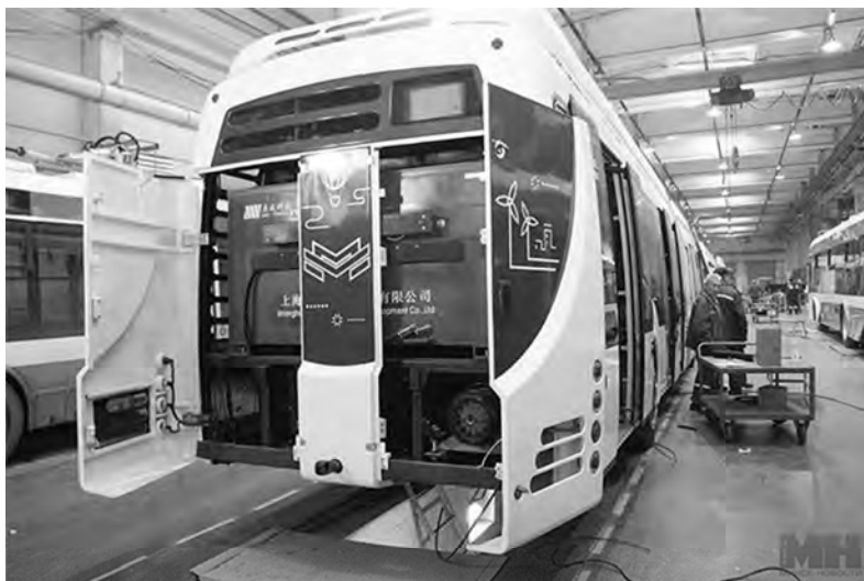
Рис. 3.4 Блок суперконденсаторов, расположенный в задней части электробуса
