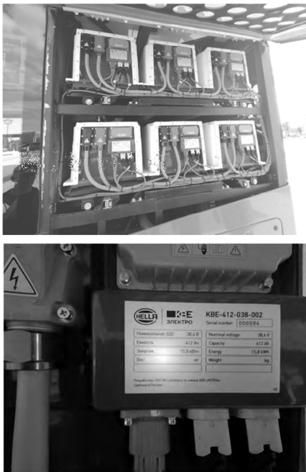
Рис. 1.18. Компоновка аккумуляторных модулей в электробусе с техническими параметрами модулей
