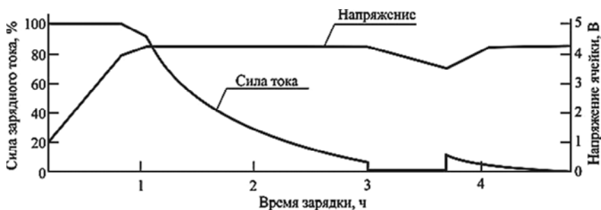
Рис. 1.9. Зарядка литий-ионного аккумулятора
