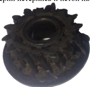
Рисунок 3 – Внешний вид изношенного на 80 процентов зубчатого колеса
