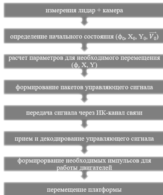
Рисунок 6 – схема управления перемещением аэродинамической платформы
