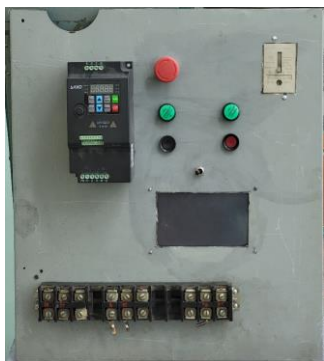
Рисунок 1 – Общий вид диагностического комплекса для определения состояния электрических машин
