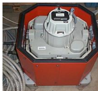
Рисунок 1 – Гиросtabilизированный гравиметр KSS 31 фирмы BODENSEEWORK
