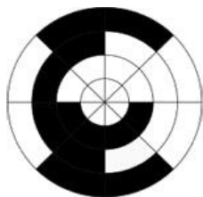
Рисунок 2 – Диск на кодах Грея
