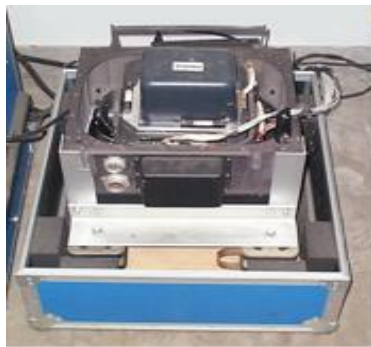
Рисунок 2 – Гиросtabilизированный гравиметр BGM-3 фирмы BELL Aerospace
