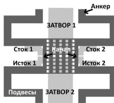
Рисунок 1 – Модель логического МЭМС вентиля с двумя затворами и двумя парами исток/сток в САПР CoventorMP
