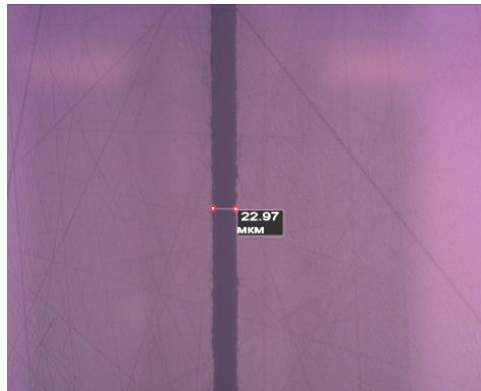
Рисунок 3 – Вид скрайберного реза на сапфировой пластине
