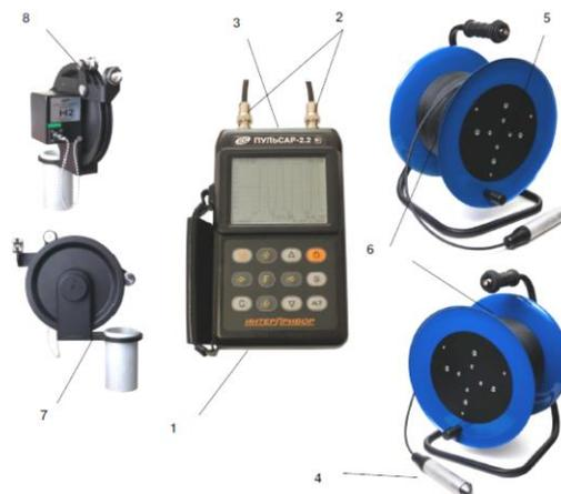
Рисунок 1 – Состав измерительного комплекса Пульсар-2.2 версия ДБС:
