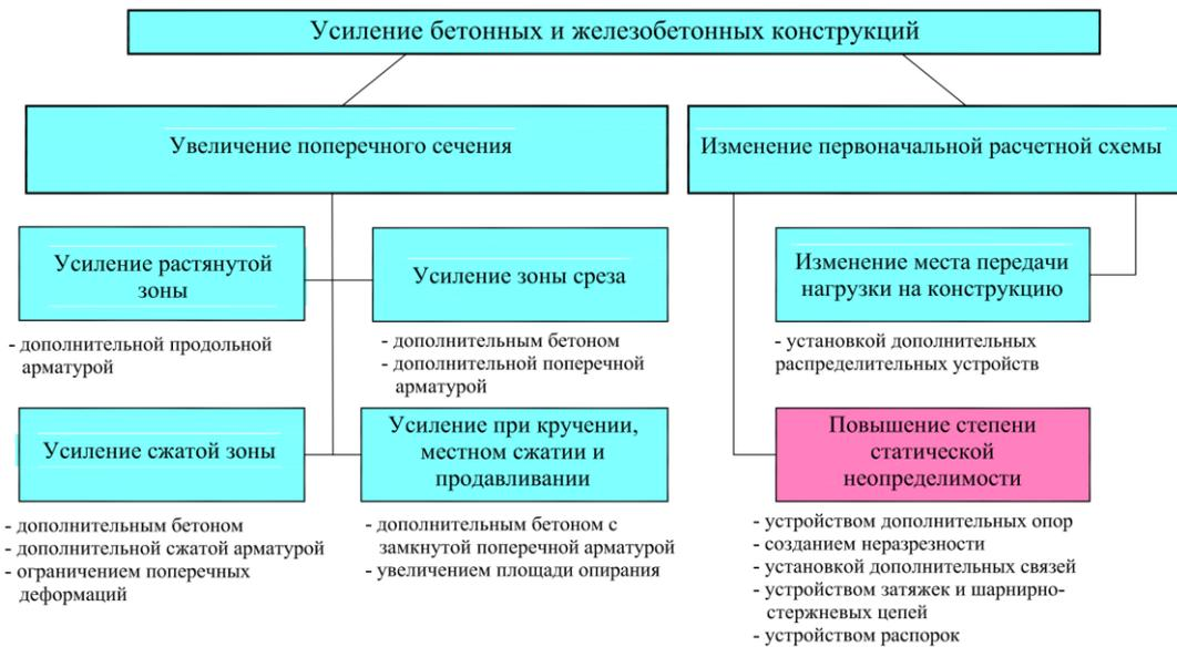
Рисунок 1 – Способы усиления бетонных и железобетонных конструкций
