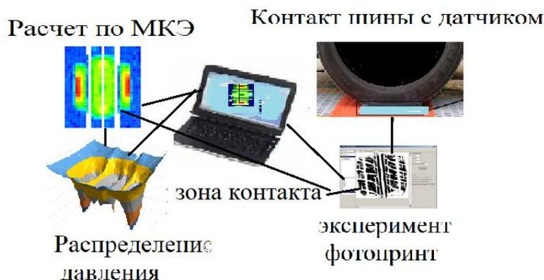
Рис. 2. Схема расчета параметров контакта
