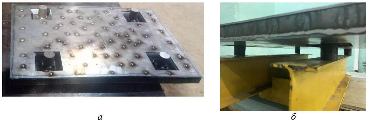
Рис. 7. Плита на стадии испытаний: *а* – вид модели плиты со стороны нижнего листа; *б* – модель плиты в испытательном стенде
