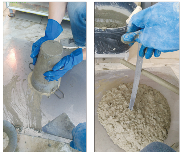
Рис. 2. Определение удобоукладываемости бетонной смеси по осадке конуса
