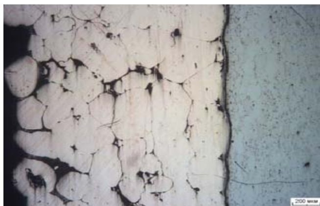
Рисунок 2 – Микроструктура композиционного двухслойного материала с порошковым антифрикционным слоем
