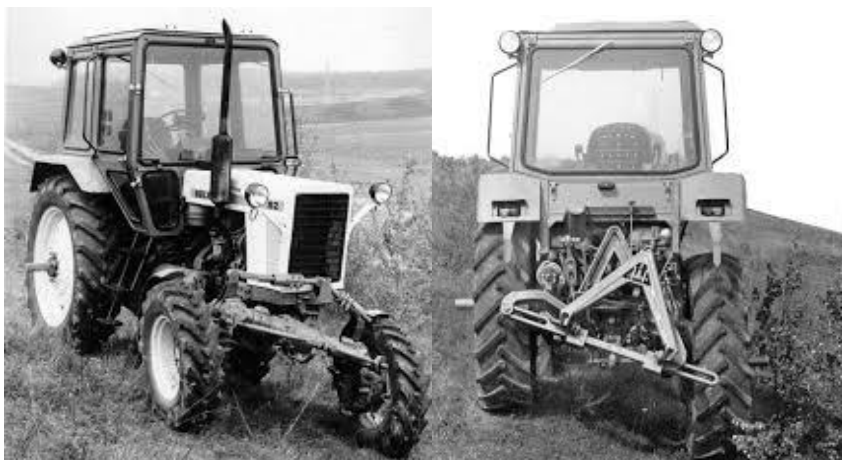
Рисунок 1 – Стабилизация положения трактора на склоне путем перемещения колес по высоте: слева – вид на передний мост; справа – вид сзади на навесную систему для агрегатирования сельхозмашин
