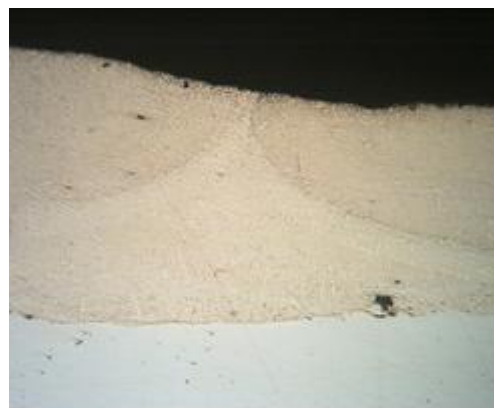
Рисунок 2- Поперечное сечение мультимодального полосчатого покрытия x50
