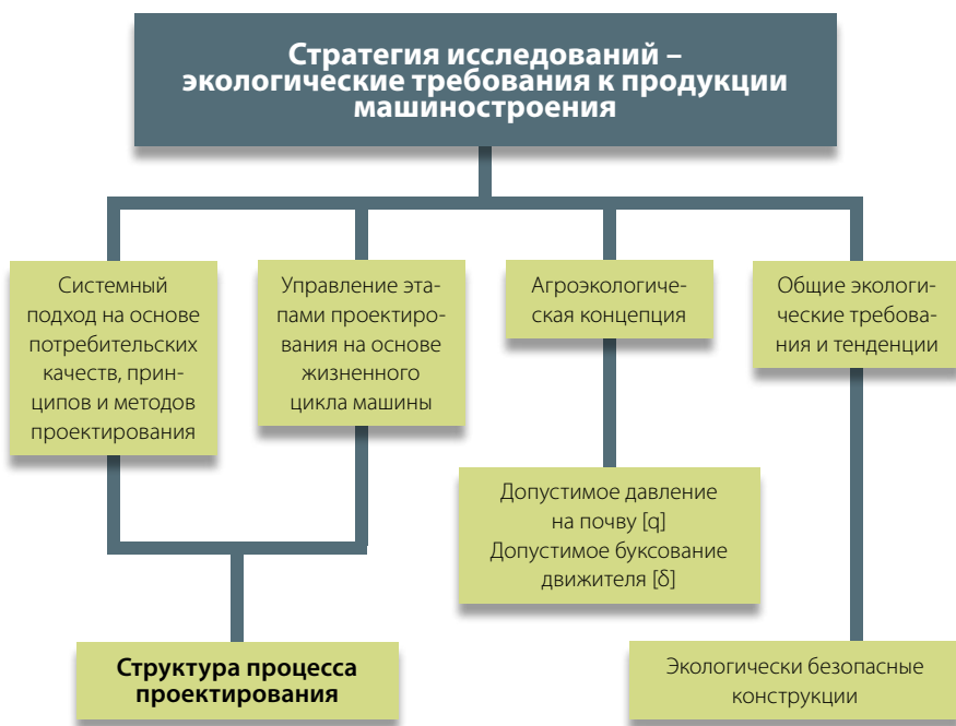
Рис. 2. Блок-схема системного подхода и методологии инженерных расчетов и проектирования ходовых систем, экологически совместимых с внешней средой. Источник: авторская разработка
