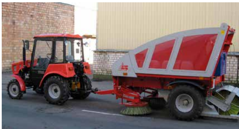
Рис. 8. Комплекты уборочной техники для тракторов малой мощности (ГНПП «Освоение в производстве новых и высоких технологий»)
