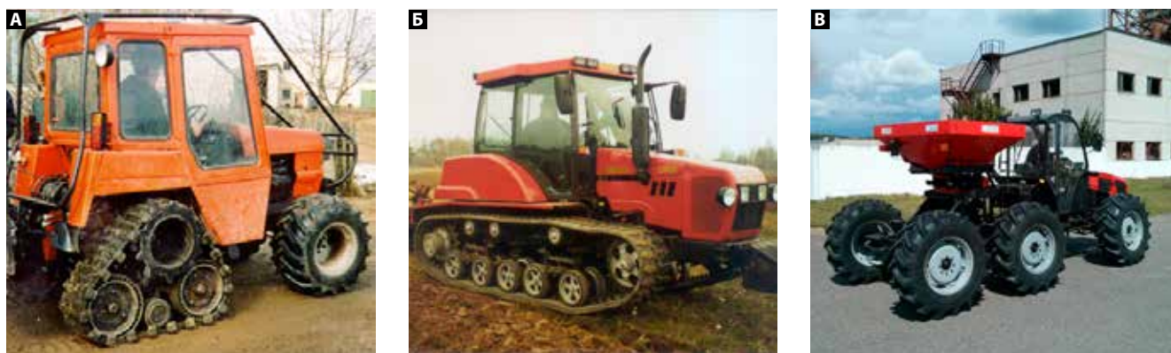
Рис. 4. Агроэкологические ходовые системы (текущие результаты): полугусеничная (А) гусеничная (Б), на шинах сверхнизкого давления (В)
