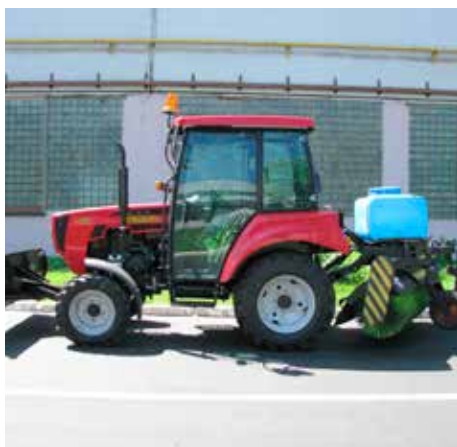
Рис. 8. Комплекты уборочной техники для тракторов малой мощности (ГНПП «Освоение в производстве новых и высоких технологий»)
