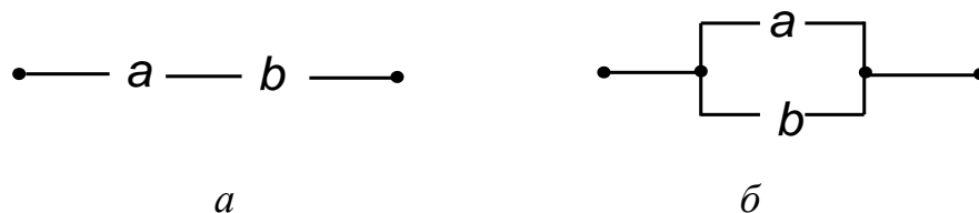
Рисунок 5.3 – Примеры последовательного ( a ) и параллельного ( б ) соединений переключателей
