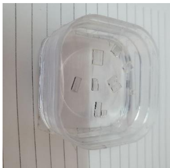
Рисунок 1 – Тестовые пластины концентрированных кристаллов \text{Yb}^{3+}:\text{KY}(\text{WO}_4)_2
