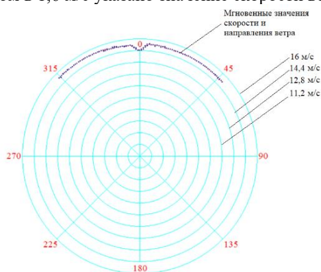
Рисунок 3 – Результаты измерений до корректировки полиномиальной зависимости при измерениях скорости воздушного потока 15 м/с
