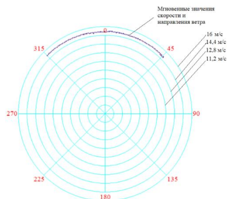
Рисунок 4 – Результаты измерений с применением корректировочного полинома, измерения производились при таких же условиях скорости
