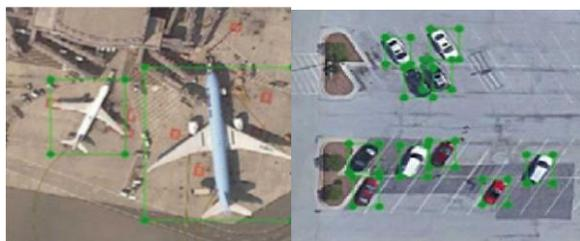
Рисунок 1 – Пример регистрации объектов системой *SatDet*
