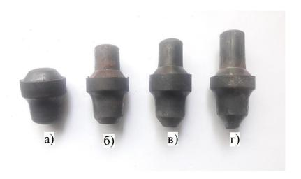
а) начальная стадия выдавливания; б) стадия формирования корпуса головной части; в) стадия формирования хвостовой части; г) завершающая стадия выдавливания Рисунок 1 — Стадии формообразования натурного опытного дорожного резца, полученного скоростным комбинированным горячим выдавливанием
