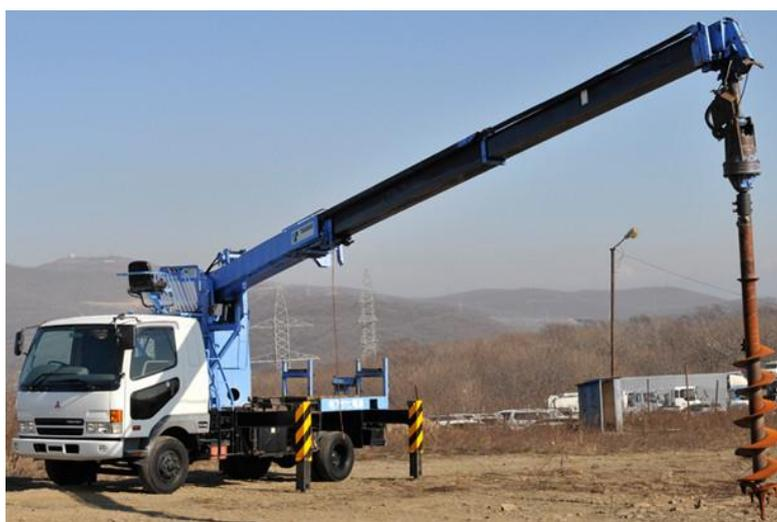
*Рис.4.16 – Погружение свай методом завинчивания при помощи вращателя, подвешиваемого на стрелу крана*
