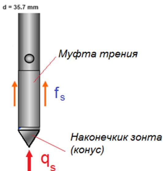
Рис. 4.32 – Схема зонда II типа.
