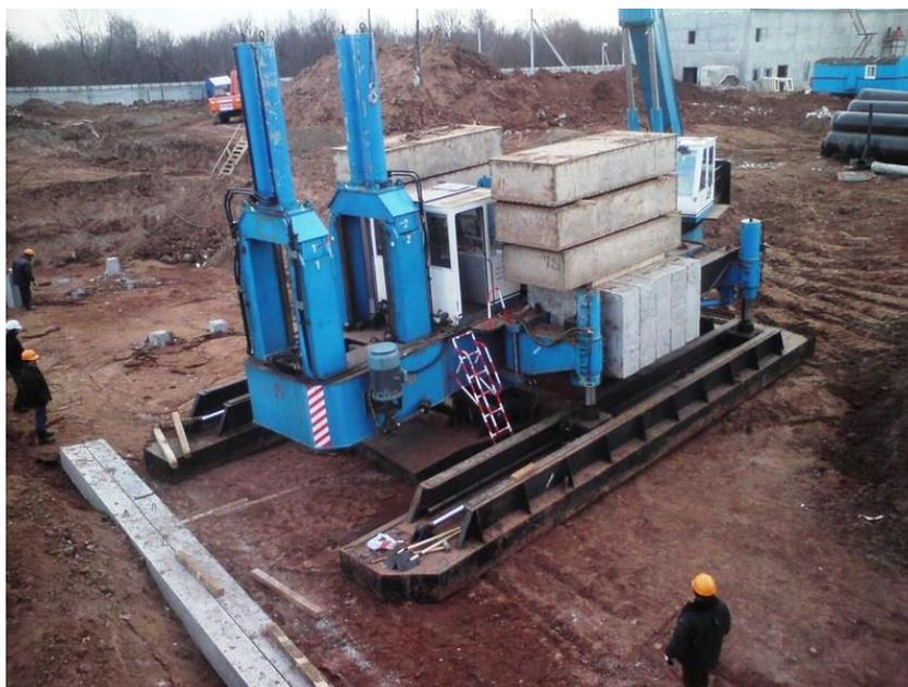
*Рис.4.15 – Общий вид сваедавливающей установки (СВУ) (<https://dismeg.ru/wp-content/uploads/3/8/e/38e9d99039d4bd4ec464a8f12131db73.jpeg>)*
