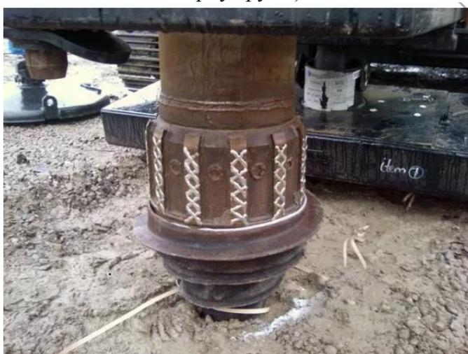
**Рис.4.27 – Металлический теряемый наконечник винтовой формы**
