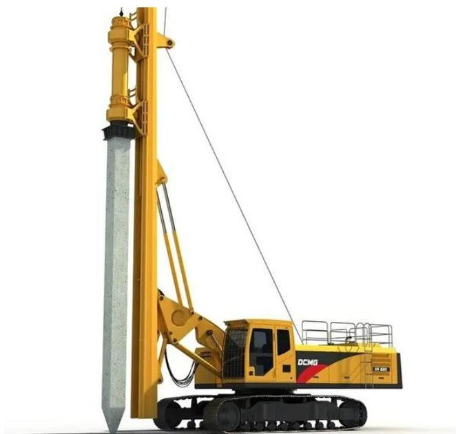
*Рис. 4.13 – Копровая установка с трубчатым дизель-молотом (<https://www.turbosquid.com/ru/3d-models/3d-pile-driver-model-1403757>)*
