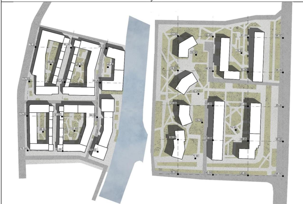
Рисунок 4. Границы участка жилой застройки. Нанесение характерных точек (расчетные точки территории нанесены через каждые 50 метров)
